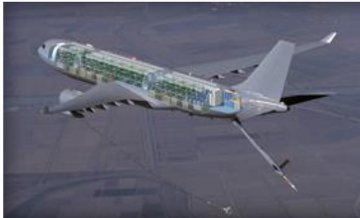
Airbus A330MRTT adalah pesawat multi role tanker transport (MRTT) yang merupakan generasi baru pesawat pengisian bahan bakar udara didasarkan pada pesawat jet penumpang A330-200. Pesawat ini dapat menyimpan 111 ton bahan bakar di sayapnya dan membawa 300 personel atau 45 ton kargo. Digunakan Angkatan Udara Australia, UEA, Inggris dan Saudi Arabia. Pesawat ini biasa melayani F-16 Fighting Falcon, F-35 Lightning II.<sup>31</sup>
